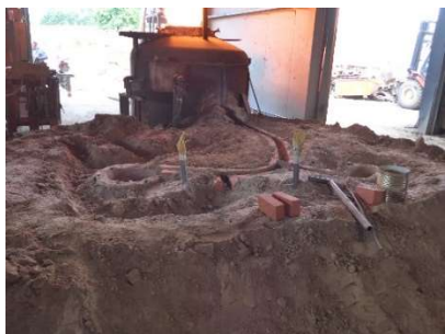
03. Juli 2020: Tag des Glockengusses Im Ofen befinden sich knapp 6 Tonnen Glockenbronze. Rechts der Gusskanal der Tuttlinger Glocke c', links zur Herrenberger Vaterunserglocke d'.
