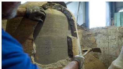
Die Glocke steht im Gießraum, das Wachs der Glockenzier ist geschmolzen und hat ein Negativ im Glockenmantel hinterlassen.
