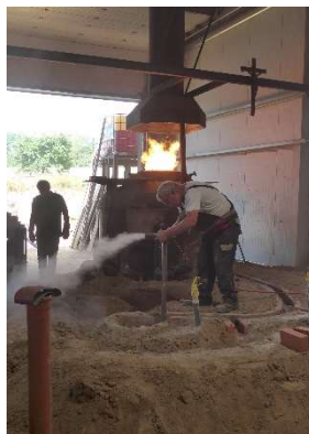
Der Gusskanal wird gereinigt
